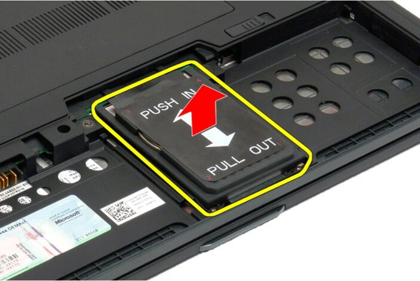
6. Extraiga la unidad de disco duro del Tablet PC.
